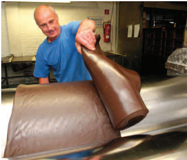
Fertig gemischt: „Elastica“-Fertigungsleiter Bogdan Steinke präsentiert eine Endlosbahn, die gerade aus der Mischwalze gekommen ist.
